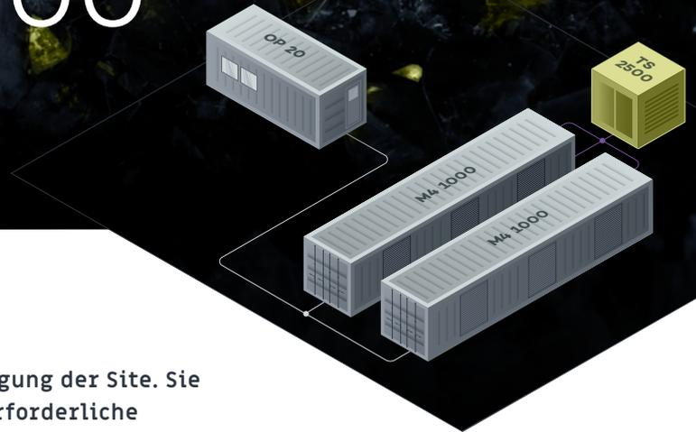
Die Trafostation sichert die stabile Energieversorgung der Site. Sie wandelt die Spannung aus dem Stromnetz in die erforderliche Niederspannung um. Geliefert wird die Einheit anschlussfertig in einem Stationsgebäude.
